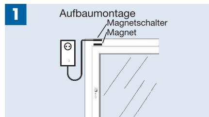
Der Magnetschalter wird an einem Fenster in der Nähe der Dunstabzugshaube montiert.
