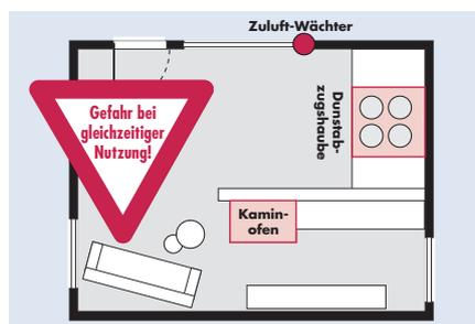
abzugshaube nur bei geöffnetem Fenster eingeschaltet werden kann, weil die Stromzufuhr bei geschlossenem Fenster unterbrochen wird. So kann genügend Luft nachströmen, den Unterdruck ausgleichen und die Verbrennungsabgase durch den Schornstein entweichen lassen.
