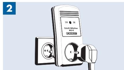
Der Zuluft-Wächter (Schaltgerät) wird in der Funk- und Kabelversion einfach zwischen den Steckern der Dunstabzugshaube und der Wandsteckdose gesetzt. Ist das Fenster geschlossen, unterbricht das Schaltgerät die Stromzufuhr und die Dunstabzugshaube kann nicht in Betrieb genommen werden.
